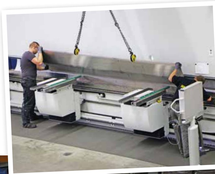
Auf den Millimeter genau kantet die neue Presse Stahl- und Edelstahlbleche.
